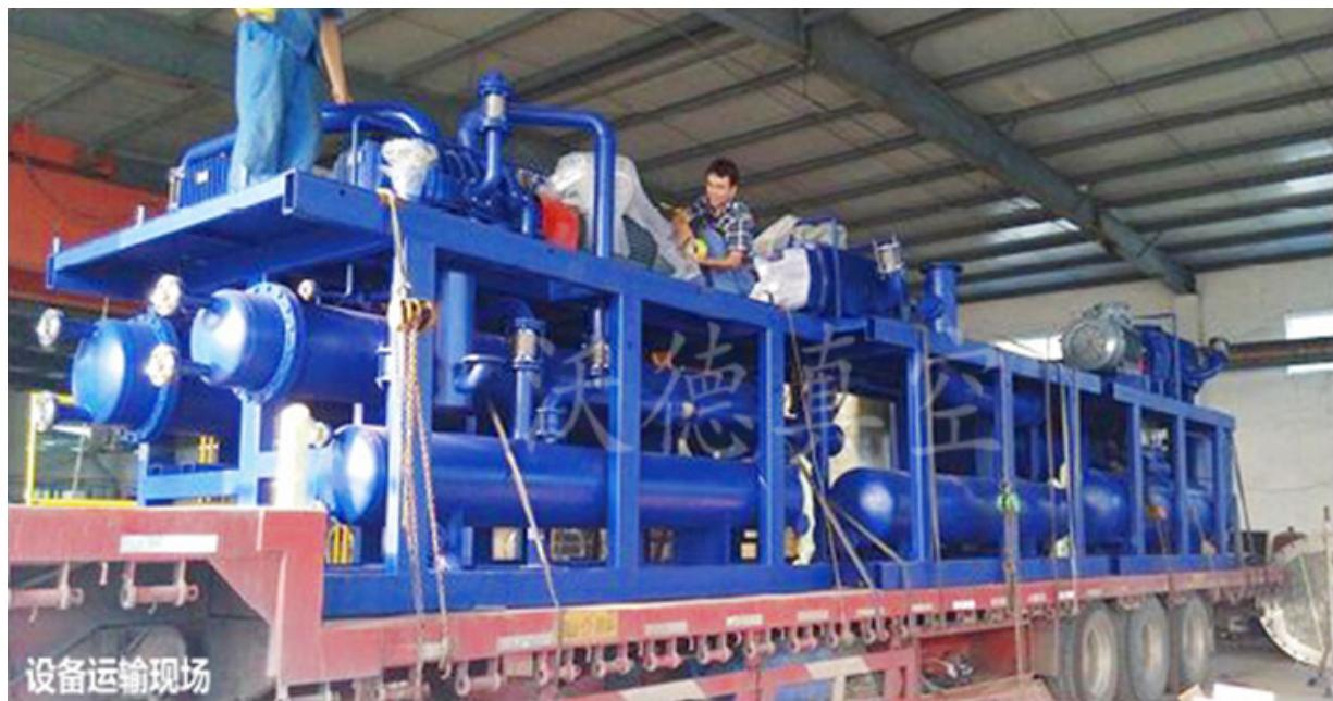
它提升了溫度、工作压力、再加温做为挥发原材料的热原，进而超过蒸气再造的目地。挥发全过程不用添加蒸气，即用小量的电磁能得到大量的能源，进而降低系统软件外部电力能源的要求，以合理的节能环保。空调蒸发器的关键部件是蒸气制冷压缩机，这是根据缩小蒸气提升蒸气溫度和工作压力的主要设备，普遍运用于粮食加工、化工厂、造纸工业、盐场、制药业等行业。MVR技术性环保节能的关键是运用二次蒸气的焓做为热原，根据缩小提升溫度，这就是说为保持循环系统挥发提升一些制冷压缩机工作中。因而，挥发浓度值能够根据挥发系统软件的自循环系统保持，而不用外界的新鮮蒸气。进而灵活运用原来废蒸气，收购汽化热，提升热效。基础理论上，选用MVR挥发技术性比传统式的多效蒸发技术性节省了80%左右的电力能源和90%左右的凝析水。以便使挥发设备尽量简易便捷，常常应用单效抽滤再制冷压缩机，或是能够是高压离心风机或增压制冷压缩机。这种设备的压缩比范畴为 $1: : 2$ ，容积总流量大。蒸气制冷压缩机是根据缩小提升蒸气溫度和工作压力的热回收系统软件的主要设备。其作用是在底压（或超低温）下充压蒸气，以考虑加工工艺或新项目需要的溫度和工作压力规定。
