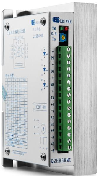
伺服驱动器[servo drives]又称为“伺服控制器”、“伺服放大器”，是用来控制伺服电机的一种控制器，其作用类似于变频器作用于普通交流马达，属于伺服系统的一部分，主要应用于高精度的定位系统。一般是通过位置、速度和力矩三种方式对伺服电机进行控制，实现高精度的传动系统定位，是传动技术中比较好的产品。伺服驱动器是现代运动控制的重要组成部分，经常被使用在工业机器人及数控加工中心等自动化设备中。尤其是应用于控制交流永磁同步电机的伺服驱动器已经成为国内外研究热点。当前交流伺服驱动器设计中普遍采用基于矢量控制的电流、速度、位置3闭环控制算法。该算法中速度闭环设计合理与否，对于整个伺服控制系统，特别是速度控制性能的发挥起到关键作用。
